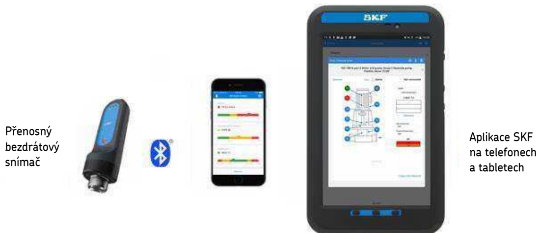
Obr. 2 - 2: Přenosný systém pro sběr dat
